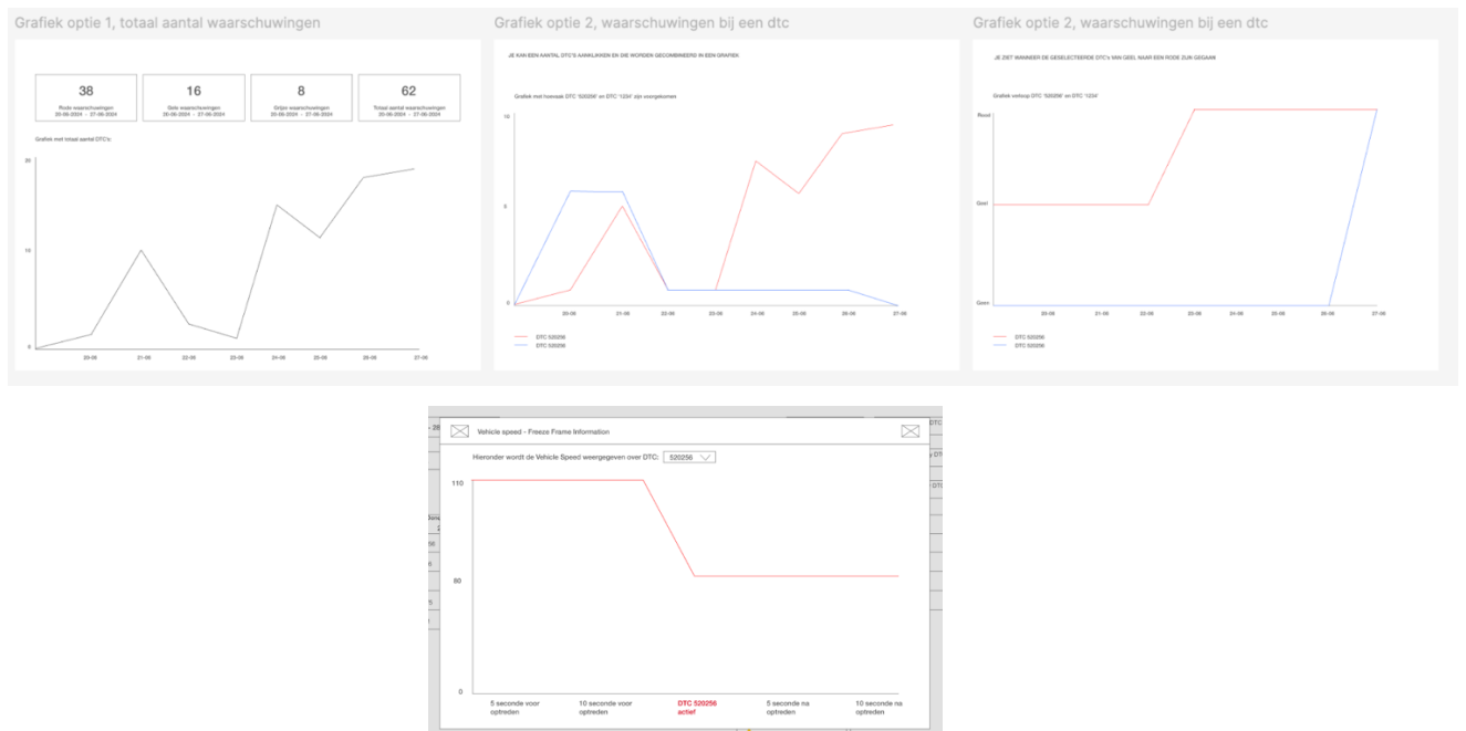
Figuur 8 toont de volgende grafieken: Linksboven: Totaal aantal DTC's. Middenboven: Frequentie van DTC. Rechtsboven: Verloop van DTC. Onder: Freeze Frame Information.
